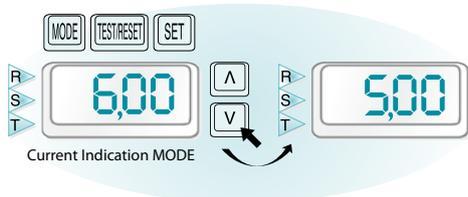
4) Установленное значение записывается при нажатии кнопки SET и отразится выбранная функция на дисплее.
