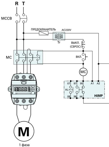
※ Выключите функцию реверса фаз при использовании однофазного двигателя
