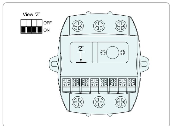
※ Установите значение утечки тока на землю и проверьте положение Дип-выключателя.
